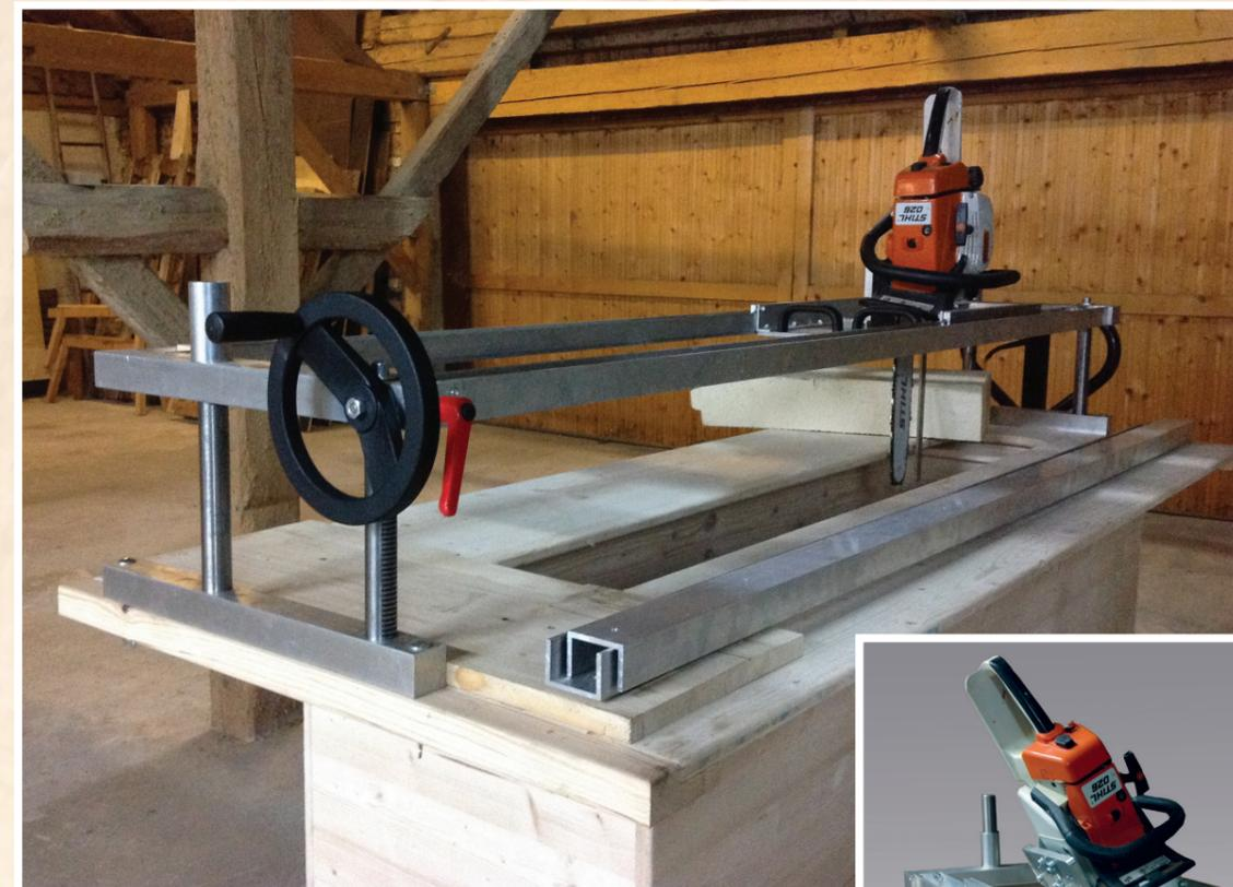
Der Schneideschlitten ist höhenverstellbar und herunterfallendes Material wird im passenden Auffangbehälter gesammelt. Eine zusätzliche Absaugung ist **nicht** nötig.
